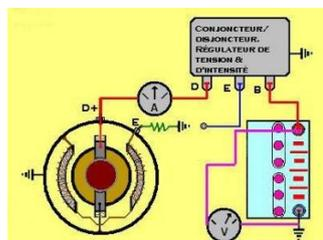
Déconnecter le câble d'excitation E (Ex) sur la dynamo, et raccorder le fil volant entre les bornes E (Ex) et une bonne masse. Accélérer :
