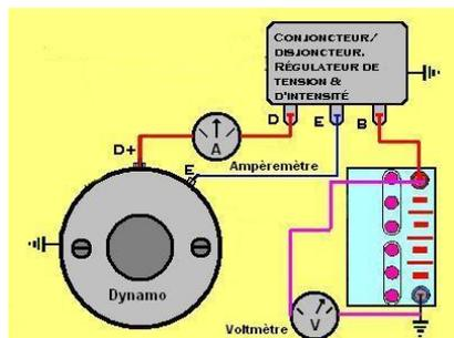
Démarrer le moteur, et accélérer : l'aiguille du voltmètre se déplace vers 6,5 à 7 V. (13 à 14 pour une dynamo en 12 V.)
