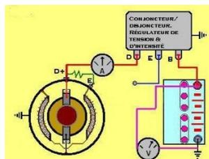
Déconnecter le câble d'excitation E (Ex) sur la dynamo, et connecter le fil volant entre les bornes D+ et E (Ex). Accélérer :
