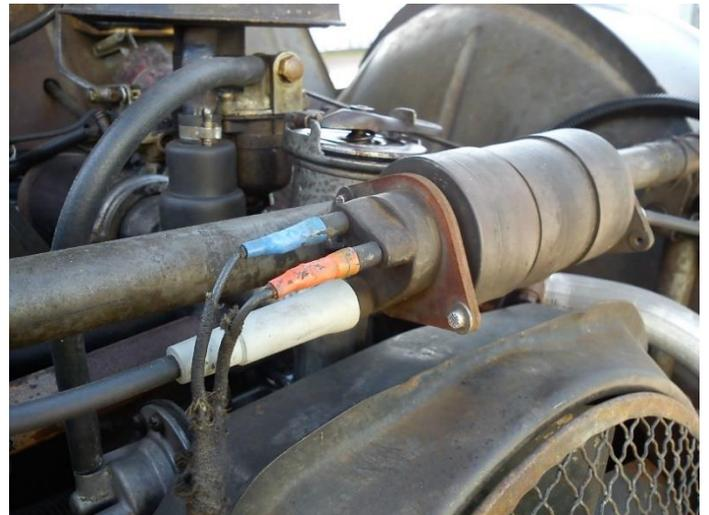
A partir de novembre 1960 et jusqu'à la fin, la 2 CV et les dérivés sont équipés d'une bobine en bakélite noire, bien connue, d'abord en 6 V. jusqu'en février 1970 pour la 2 CV, puis en 12 V. L'isolant est de l'huile. Les fiches du faisceau font alors 3mm. Aussi, les premières bobines bakélite étaient-elles vendues avec des adaptateurs pour pouvoir les monter à la place des bobines en caoutchouc précédentes.
