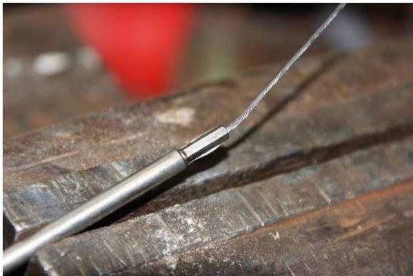
2. Percer en bout de la tige un trou de 2 mm sur environ 7 mm de profondeur.
