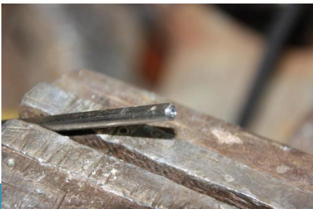
3. Enfiler le bout du câble dans le trou en bout de la tige pour le faire sortir par l'autre. Replier le bout de câble qui dépasse et le couper à ras de la tige
